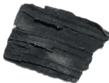
Posibles causas de la avería: fragmentos del catalizador
